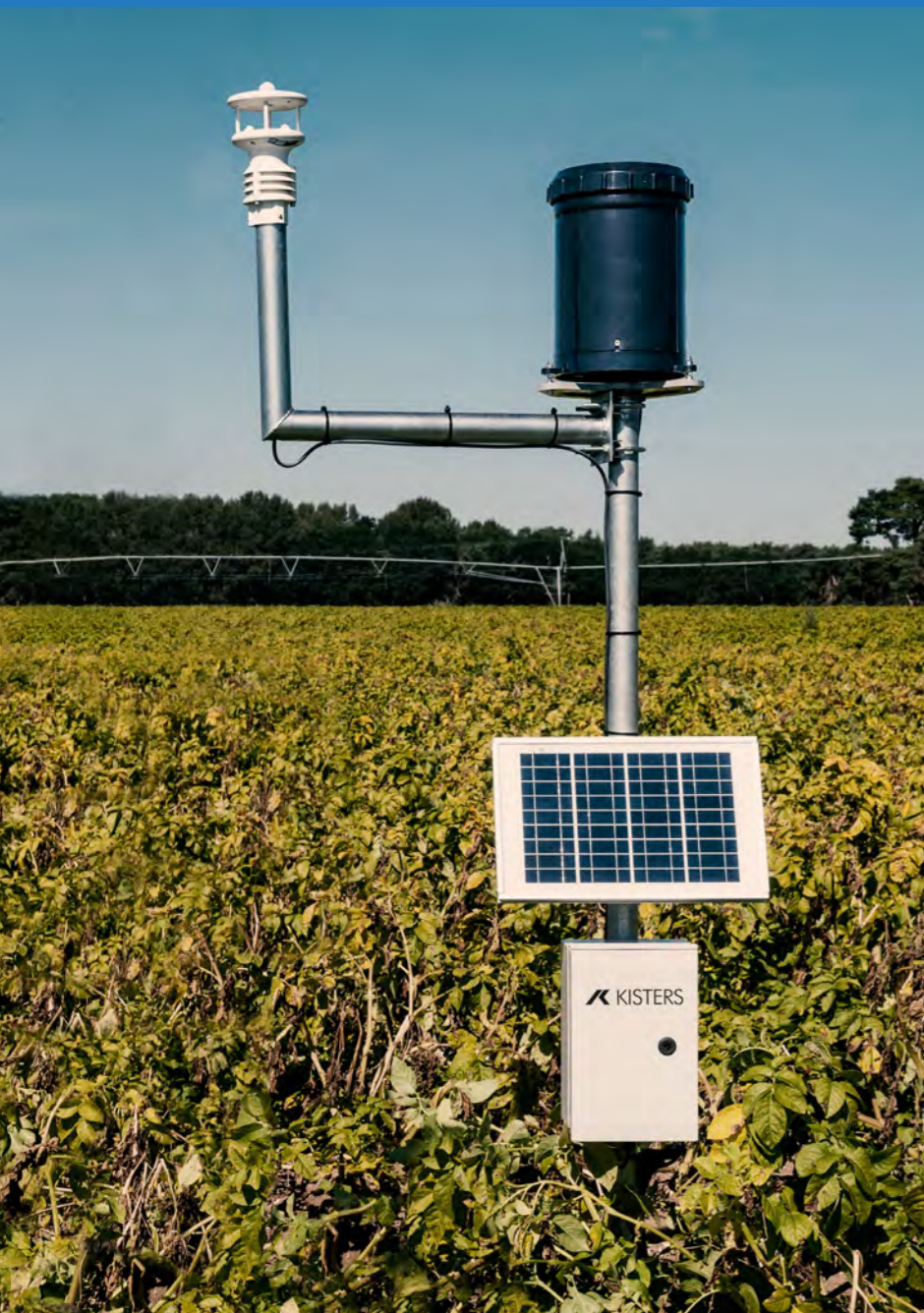
FieldRay Plant Protection/Protección plantas - Estación de control agrometeorológico: Pluviómetro con panel solar (izquierda), Estación meteorológica que mide la velocidad del viento, la radiación solar, la temperatura, la humedad relativa y la dirección del viento (derecha)
